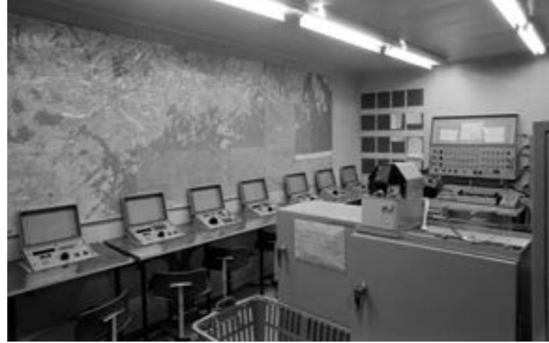
Rannikkotyökistön ammunnan ja valvonnan automaattinen laskin (RAVAL) oli seuraava rannikkotyökistön kehitysaskel RADAL-laitteistosta 1980-luvun alussa. Järjestelmä yhdisti tutkavalvonnan tilannekuvan, aistimerivalvonnan ja ammunnan laskennan.
