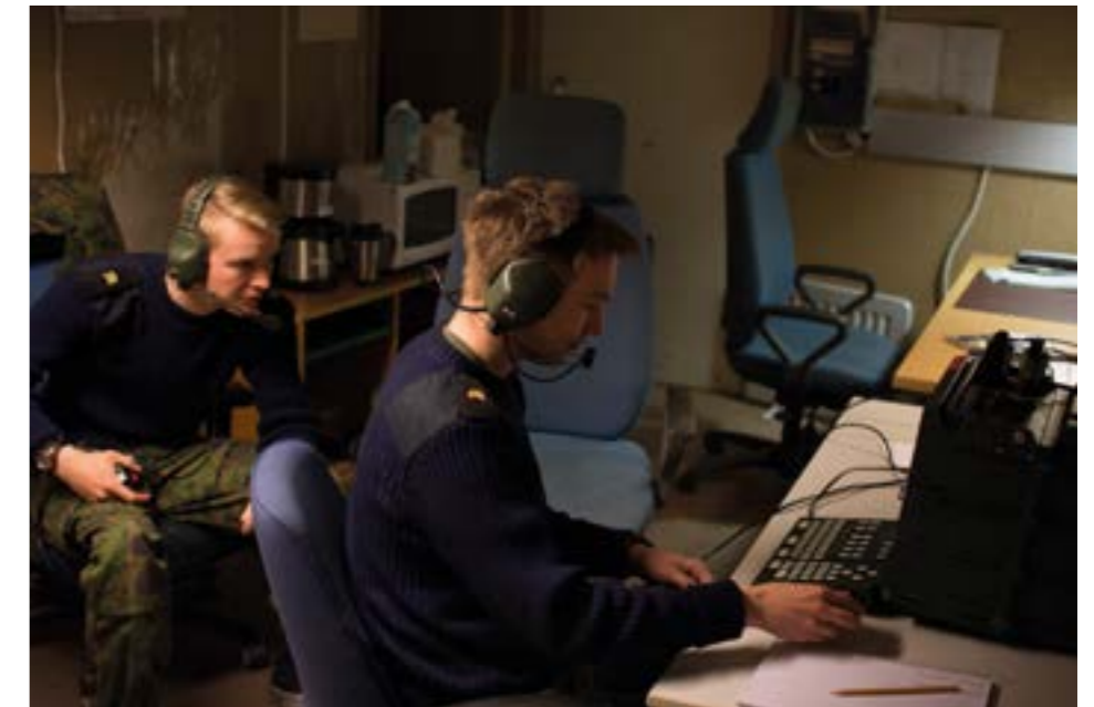
Patterilaskin oli digitaalinen laskin, jonka kautta siirryttiin 1990-luvun loppupuolella uuteen aikakauteen RAVAL-laitteiden jäädessä enemmän merivalvontaan. Patterilaskimen avulla tulenjohtajan mittausarviot ja ammunnan valmistelu yhdistyi ampuville yksiköille ampuma-arvoiksi. Laskin kykeni useamman yksikön ammunnan valmisteluun ja se on yhä vieläkin käytössä rannikopattereiden tulitoiminnassa. 130TK tykkien omat tykkikohtaiset laskimet täydentävät vielä tulenkäytön kykyä.
