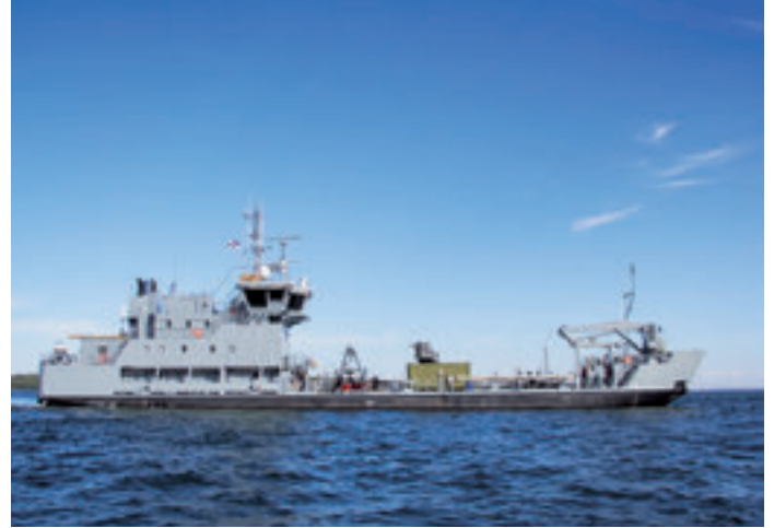
Öljyntorjunta-alus Hylje koki muodonmuutoksen peruskorjauksessa, joka valmistui toukokuussa. Alus sai muun muassa 10 metriä lisää pituutta ja paljon uusia käyttöominaisuuksia.
