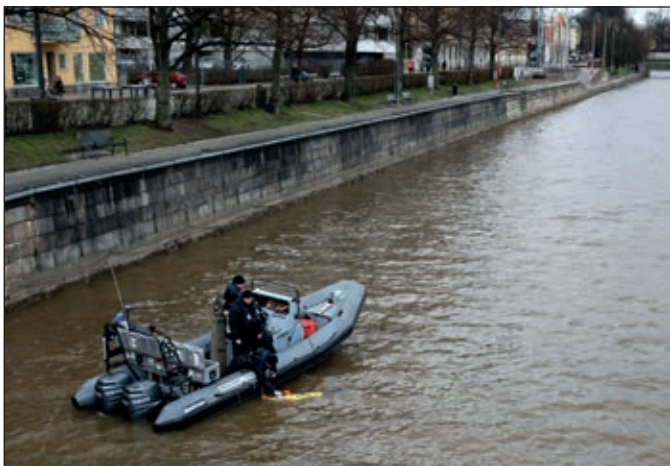
Rannikkolaivasto osallistui Aurajoessa järjestettyyn Puhtaat rannat -tapahtumaan huhtikuussa. Miinantorjunta-alus Katanpään irrotettavaan kalustoon kuuluvalla, RHIB-veneeltä ope- roitavalla AUV Remuksella kartoitettiin joen pohjaa. Tieto ylös nostettavien kohteiden sijainnista helpotti sukeltajien työtä ta- pahtuman myöhemmässä vaiheessa.
