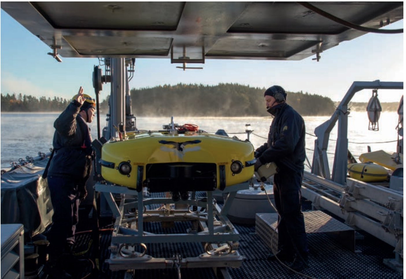
Katanpää-luokan miinantorjunta-alusten kalusto on monipuolinen. Kuvan ROV (Remote Operated Vehicle) toimii veden alla mm. tunnistustehtävissä.
